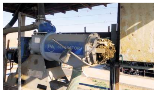
Shahryar Saffari travaille avec un séparateur FAN 3.2 780 pour une séparation solide-liquide très efficace.
