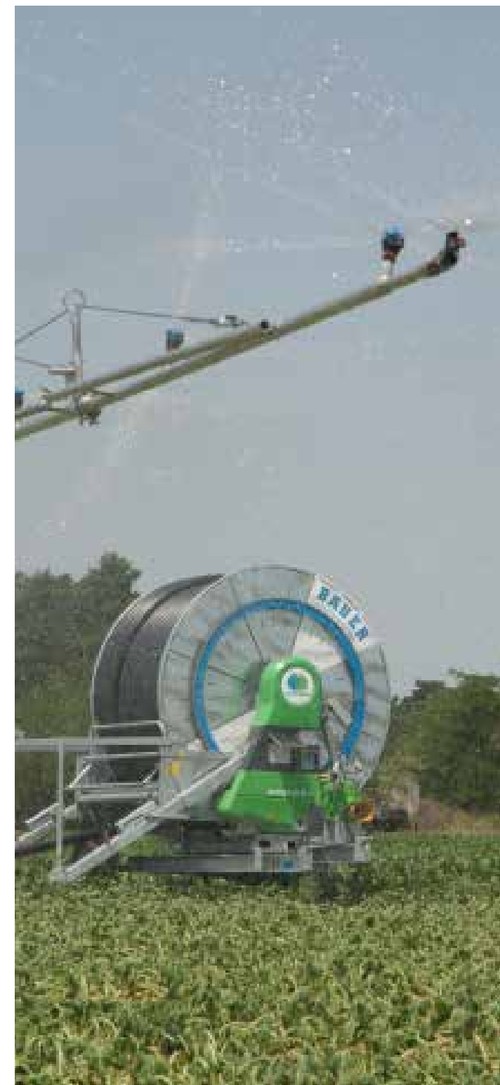
Des systèmes de bras à tuyères spécialement conçus réduisent le besoin en énergie des machines à enrouleurs
