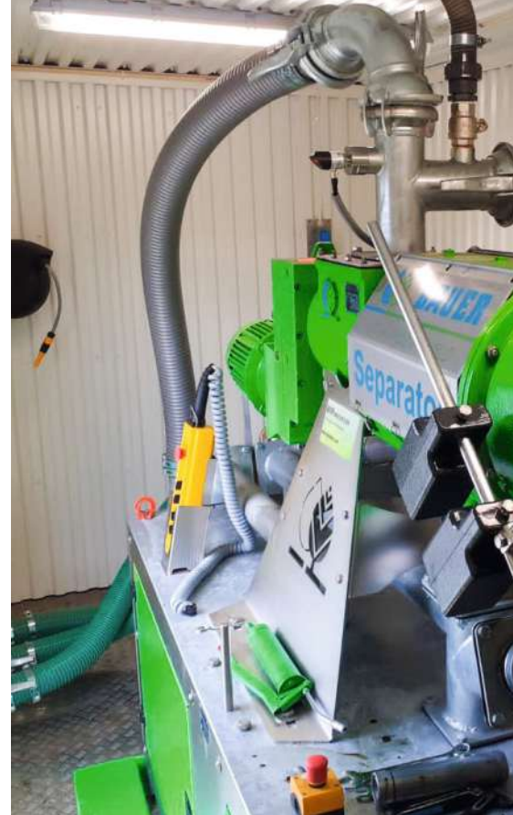
Plug & Play S855 GB превращает навоз КРС в идеальную органическую подстилку для стойл для отдыха дойных коров.
