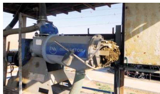
Shahryar Saffari arbeitet mit einem FAN Separator 3.2 780 für effizienteste Fest-Flüssig-Trennung.
